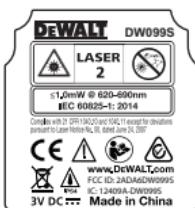
Las herramientas DW099E y DW099S emiten un rayo láser visible, como se muestra en la figura (A) #1. El rayo láser emitido es un Láser Clase 2 en conformidad con la norma IEC 60825-1 y cumple las normas 21 CFR 1040.10 y 1040.11, excepto en las desviaciones en conformidad con lo establecido en Laser Notice No. 50, del 24 de junio de 2007.
